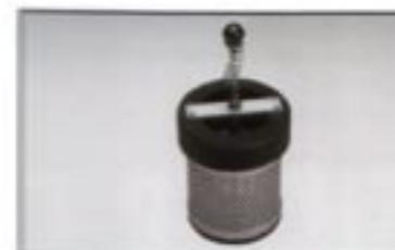
Bezpečnostní ventil Pro bezpečné zdvihání pomocí přípravků a svěrek. Je umístěn mezi zdvihací hadicí a ovládací jednotkou. Eliminuje okamžitě podtlak uvnitř zdvihací hadice, pokud je břemeno nechtěně uvolněno.
