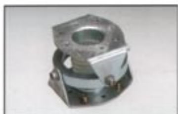
Vyvažovací adaptér Upevněn mezi zdvihací hadicí a ovládací jednotkou. Drží zdvihací hadici ve vertikální poloze, i když se břemeno nakloní (břemena s asymetricky uloženým těžištěm).
