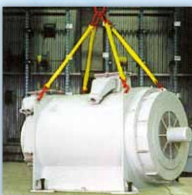
Textilní vázací prostředky jsou ideálním prostředkem určeným k manipulaci s břemeny ve všech provozech, kde je zajištěno jejich správné používání. Vyznačují se nízkou hmotností, což obsluze výrazně usnadňuje práci. Vyrábí s v nosnostech až do 150 t.
