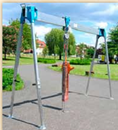
portálový jeřáb s volitelným příslušenstvím: vozík se zámkem LF, ruční řetězový kladkostroj HZB, ocelová svěrka typ STZ
